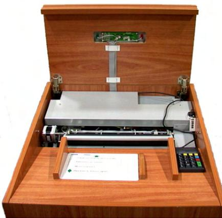
Сканирование оригинала производится одновременно с двух сторон. Привод сканера автоматически включается при подаче оригинала на вход тракта и выключается после сканирования. Время двустороннего сканирования черно-белого оригинала формата А4 - 1.5 сек, разрешение - 200 dpi
